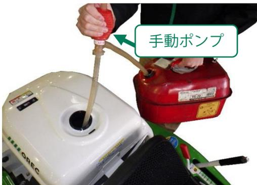
・手動ポンプを使って、燃料タンク内の燃料を携行缶に戻してください。
