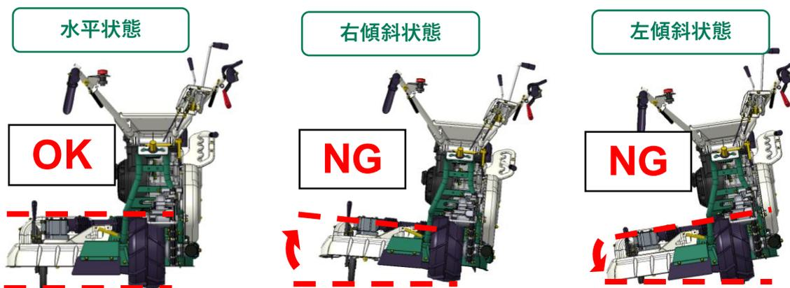
※エンジンベースが前後及び左右方向に水平でない場合、オイルを正しく確認できないので注意してください。オイル量はエンジン型式で異なりますので、詳細は取扱説明書を参照してください。
