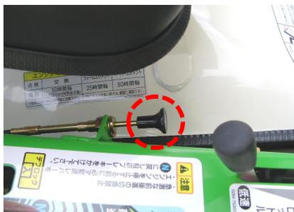
引けば『閉』位置、戻せば『開』位置となります。寒冷時のエンジン始動時に『閉』位置で始動させ、始動後は『開』位置に戻してください。
