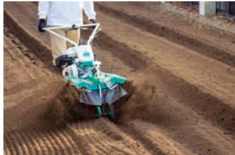
溝堀作業 (別売:溝堀ローターセット)
